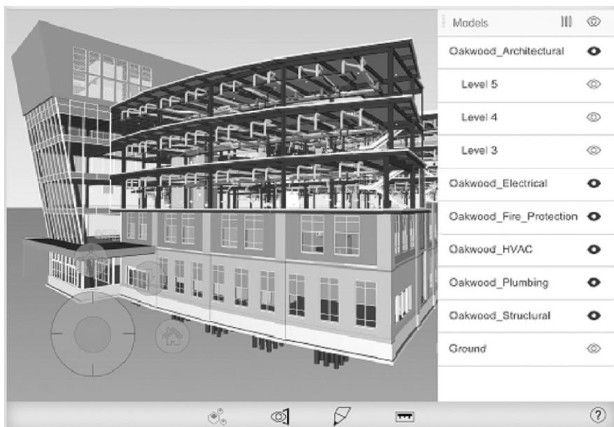
Рис. 4. 3D-модель здания, построенная с помощью BIM
