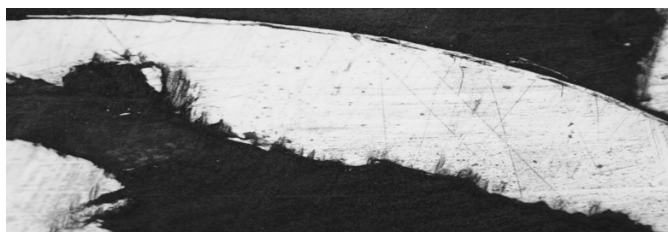
Рис. 1. Фотография микроструктуры исходной заготовки из стали 40Х (X200)
