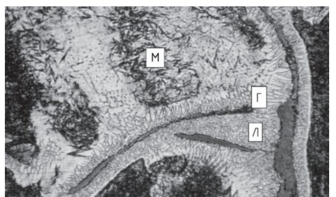
Рис. 8. Влияние лазерной обработки на коэффициент трения и скорость изнашивания образцов из серого чугуна в паре трения «стальной диск – чугунная колодка»: верхний ряд фотографий – вид поверхности трения после испытаний, нижний – микроструктура металла в зоне трения; Г – графит; Л – ледебурит; М – мартенсит; П – перлит
