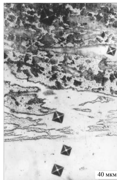
Рис. 3. Высокопрочные структуры, сформированные в сварном шве со стороны хромоникелевой стали
