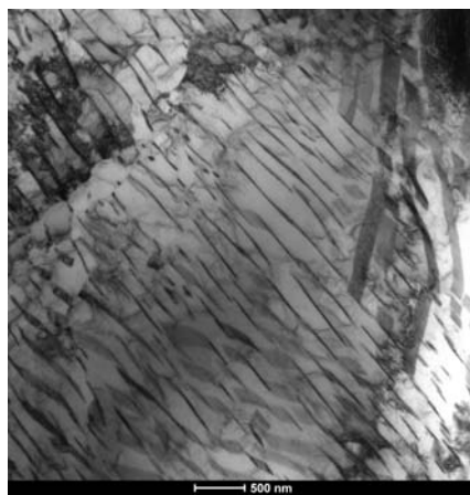
Рис. 4. Тонкое строение сварного соединения между рельсовой и хромоникелевой сталями (см. также с. 27)
