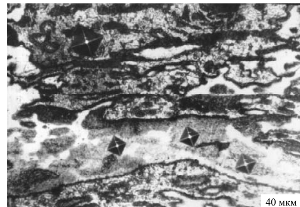
Рис. 2. Закаленные области в переходной зоне сварного шва со стороны рельсовой стали
