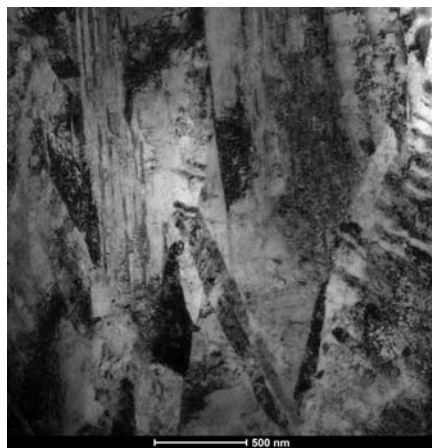
Рис. 4. Тонкое строение сварного соединения между рельсовой и хромоникелевой сталями (см. также с. 27)
