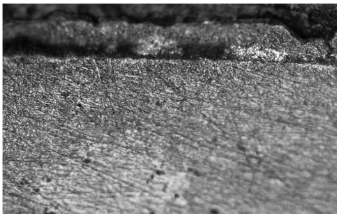
Рис. 4. Отслоение приповерхностного слоя вследствие высоких контактных температур ( \times 500 )
