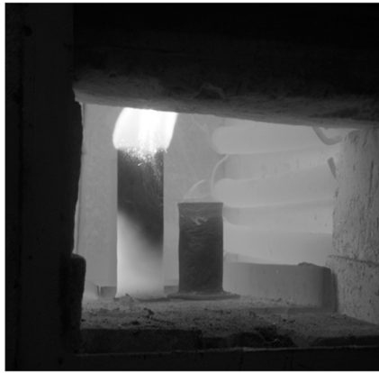
Рис. 1. Процесс восстановления хрома при температуре 1000 °С
