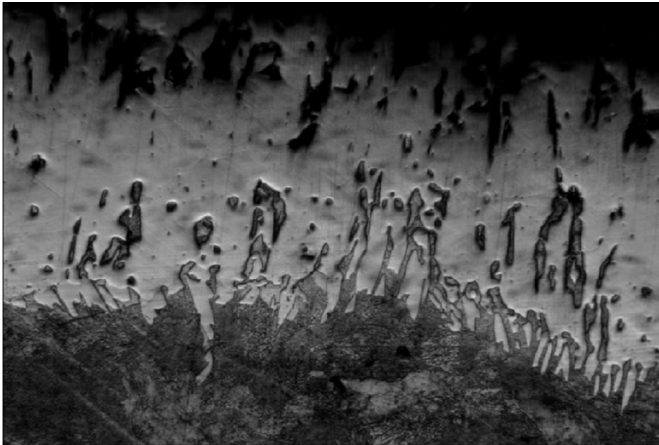
Рис. 3. Микроструктура диффузионного слоя на стали 45 при введении в состав оловянистой бронзы х400 ( t = 950\text{ }^{\circ}\text{C} , \tau = 5 )
