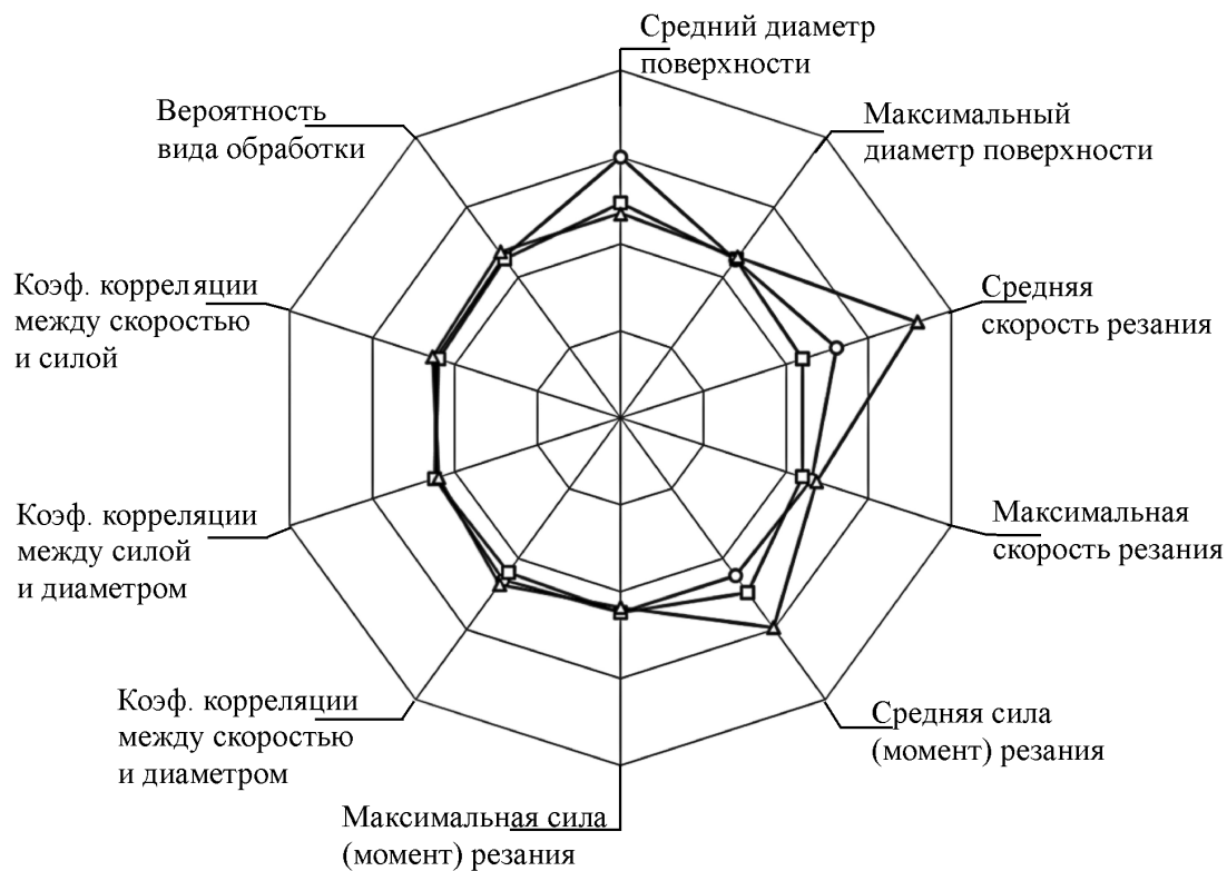
Рис. 3. Влияние исходных параметров на надежность прогноза универсальных станков
