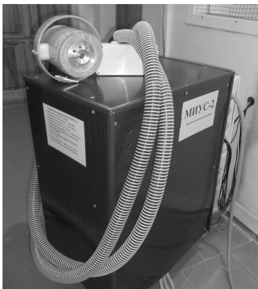
Рис. 2. Магнитно-импульсная установка МИУС-2 с кабельным подключением совмещенного СУ цилиндрического типа
