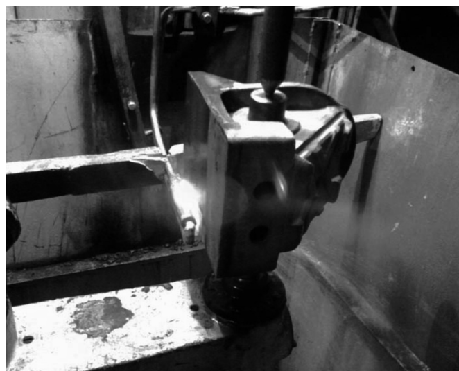
Рис. 3. Фотография процесса закалки клина
