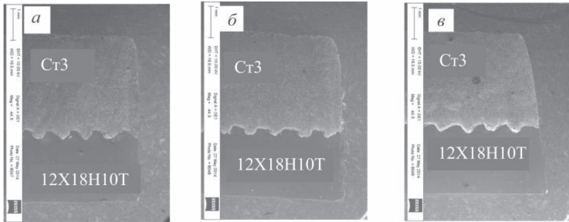
Рис. 16. Геометрия реза биметаллической композиции «сталь Ст3 + сталь 12X18H10T» при раскросе со стороны стали Ст3 по технологической схеме Ni – Focus plus для углеродистых сталей:
