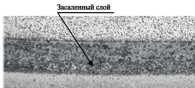
Рис. 1. Поверхность алмазного круга со следами засаленного слоя после шлифования быстрорежущей стали P 6 M 5
