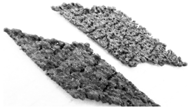
Рис. 2. Влияние каплеобразования на качество поверхности при спекании слоя порошка
