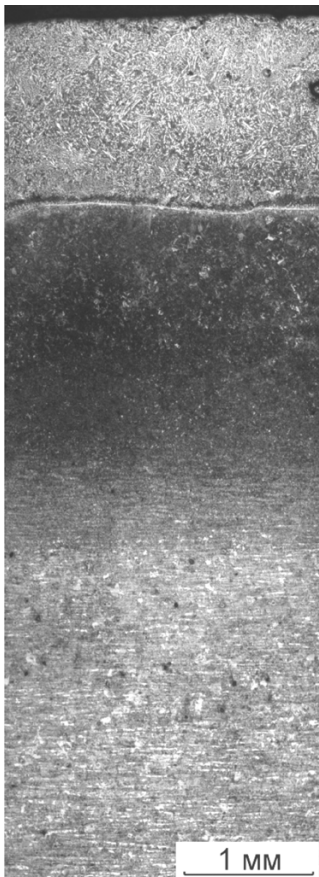
Рис. 1. Общий вид образца из стали 40X с наплавленным покрытием
