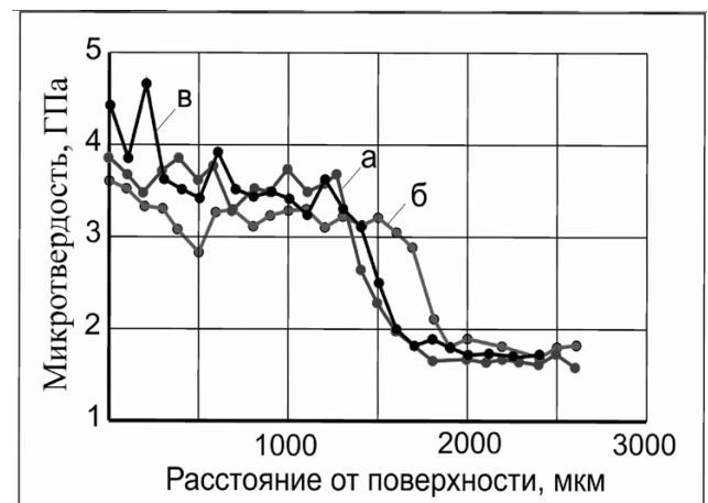
Рис. 4. Распределение микротвердости по глубине наплавленного слоя:
