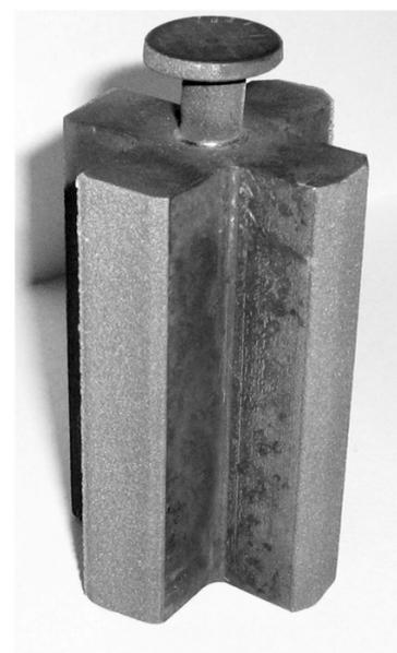
Рис. 6. Внешний вид вкладыша после плазменного напыления
