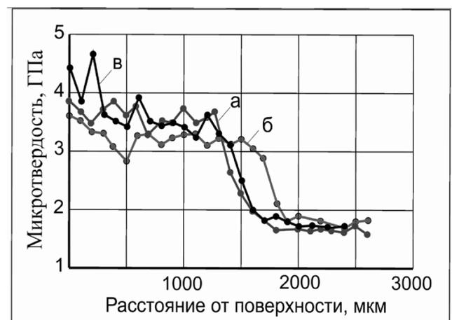
Рис. 4. Распределение микротвердости по глубине наплавленного слоя:
