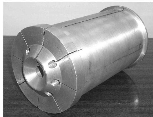
Рис. 1. Совмещенное согласующее устройство цилиндрического типа:
