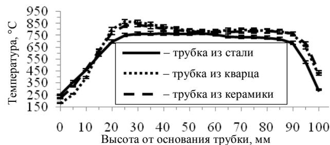
Рис. 6. Профиль температуры поверхности трубки с внутренним диаметром 15 мм в зависимости от материала стенки при значении  $\varphi = 0.95$  и расходом топлива  $1,5 \cdot 10^{-4} \text{ м}^3/\text{с}$
