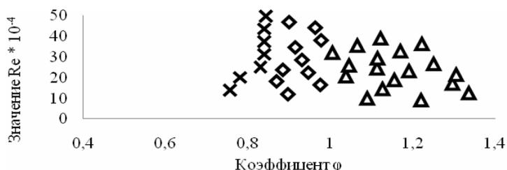
Рис. 3. Предел устойчивости пламени для стальной трубки с внутренним диаметром 15 мм
