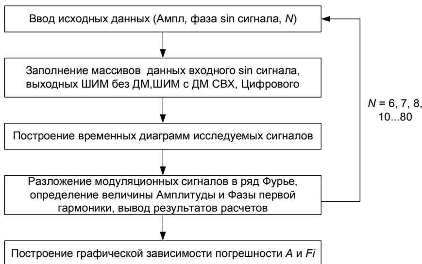
Рис. 3. Алгоритм исследования различных видов дискретизации синусоидального сигнала
