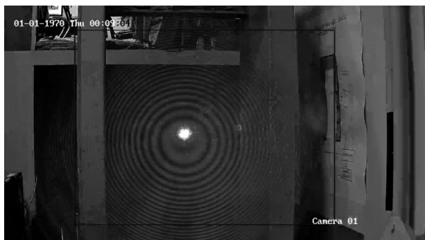
Рис. 16. Изображение с камеры при воздействии лазера
