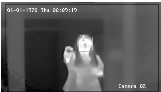
Рис. 17. Изображение с тепловизора при воздействии лазера
