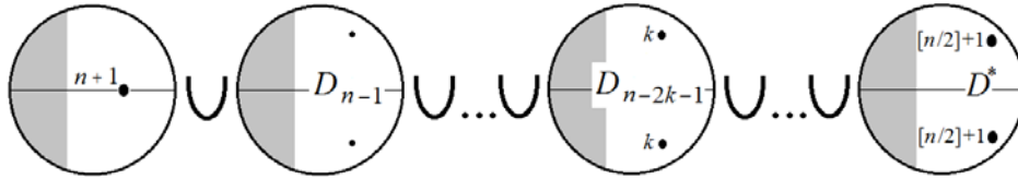
Рис. 4 – Схема построения множества D_n критических корневых диаграмм рекурсией из множеств D_k меньших размерностей. Для нечетного числа n D^* = D_0 , для четного числа n множество D^* пусто
