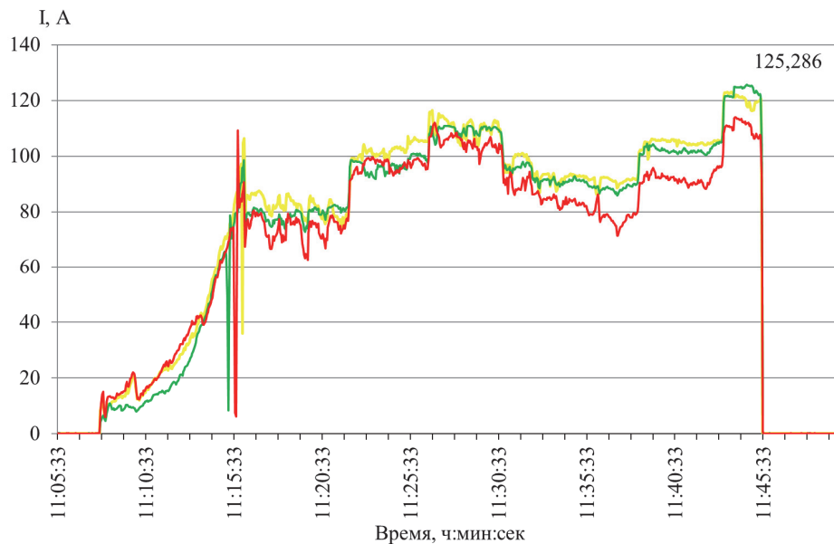
Рис. 3 – Токи фаз A , B и C реактора с сериями обмотками
