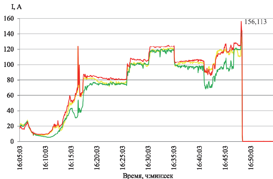
Рис. 6 – Токи фаз A , B и C реактора с отключенными серийными обмотками
