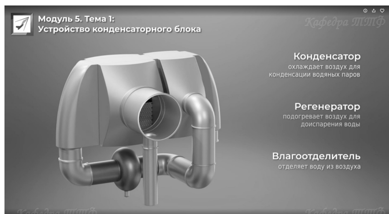
Рис. 1 – Устройство конденсаторного блока
