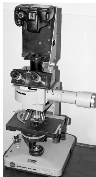
Рис. 1 – Фотография микроскопа цитофотометрической установки
