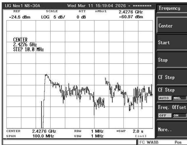
Рис. 13. Изменение мощности сигнала при различных угловых положениях полуволнового диполя (4-е положение)
