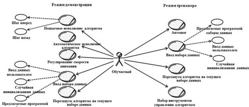
Рис. 1. Функциональная диаграмма визуализатора
