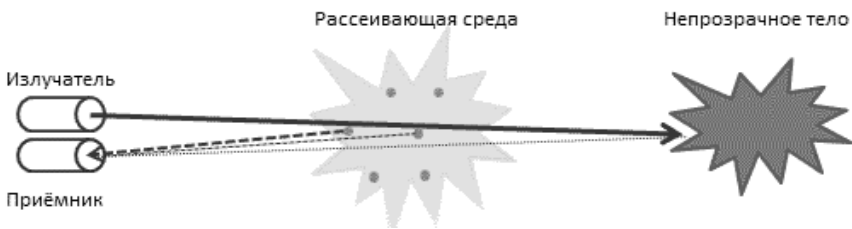
Рис. 1. Принцип действия лидара
