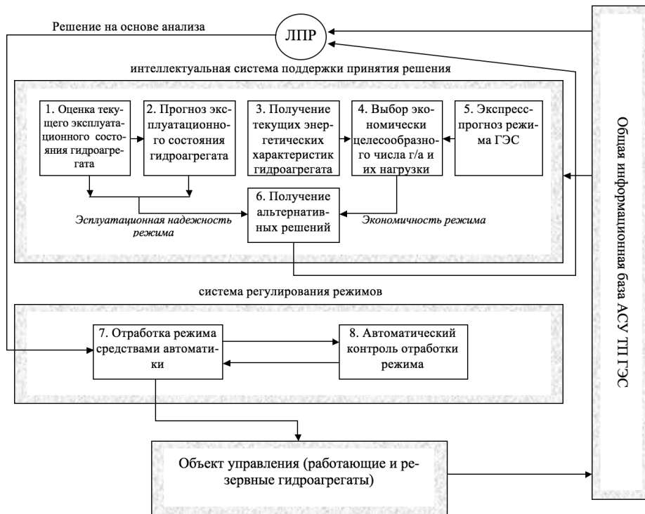
Рис. 3 – Структура задач оперативного управления составом агрегатов на ГЭС
