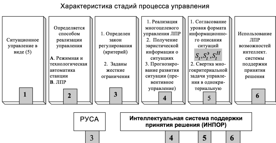
Рис. 2 – Ситуационное управление составом агрегатов на станции
