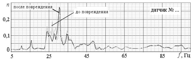
Рис. 3 – Определение места возникновения дефекта по АЧХ
