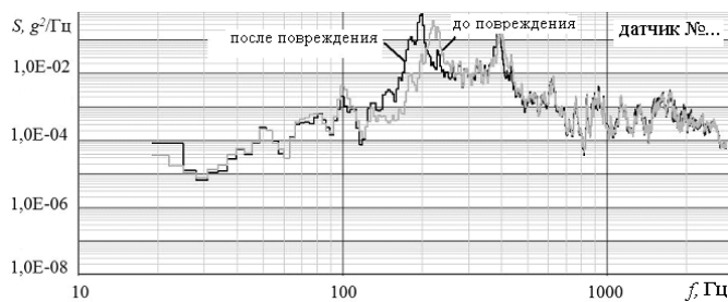
Рис. 4 – Определение места возникновения дефекта по СПМ
