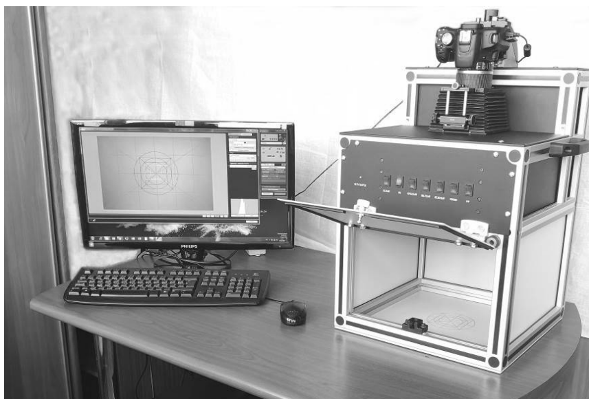
Рис. 4 – Общий вид прибора «Фотобокс 3138». Одна из стенок рабочей камеры сделана откидной – для простоты работы с объектом фотосъемки. Сверху расположен блок крепления фотокамеры. По бокам корпуса расположены рукоятки для переноски и для позиционирования камеры при измерениях. На экране монитора – изображение тестовой пластины
