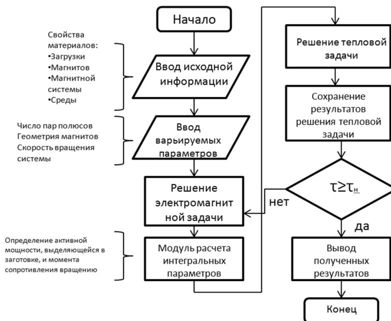
Рис. 2 – Алгоритм расчета взаимосвязанной электромагнитной и тепловой задачи:
