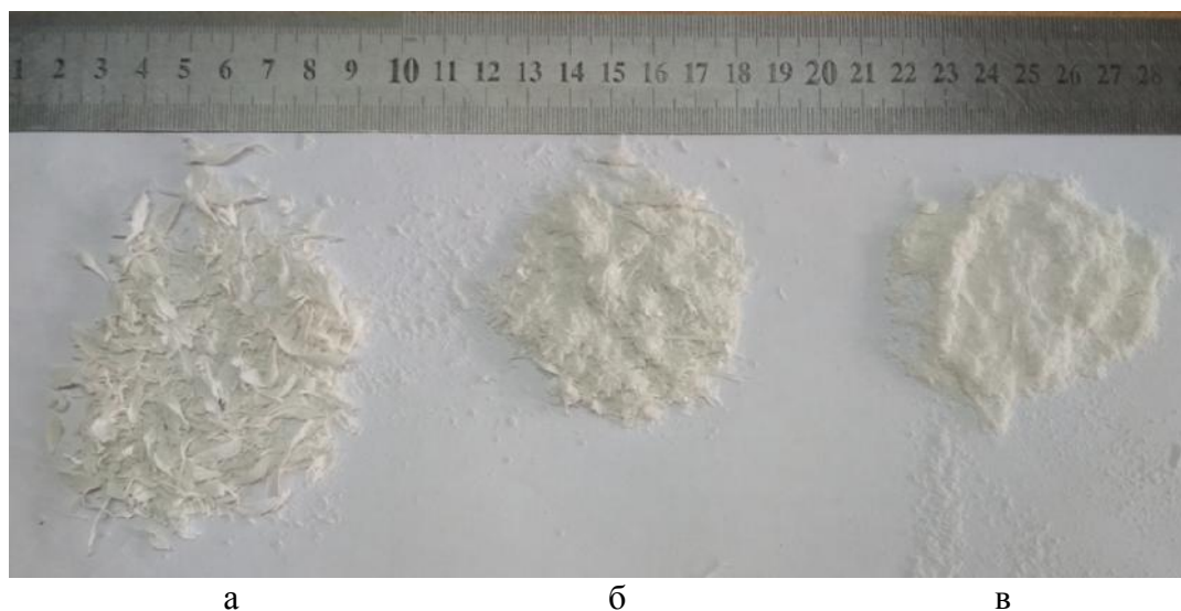
Рис. 3. Виды стружки на различных стадиях износа фрезы: а - острозаточенный инструмент; б - износ по задней поверхности от 0,15 до 0,25 мм; в - износ по задней поверхности от 0,25 до 0,35 мм.
