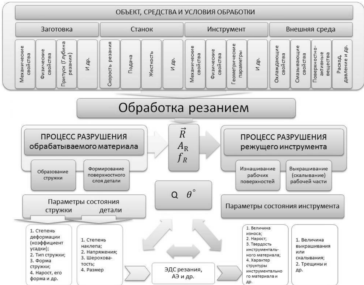
Рис. 3. Взаимосвязь параметров в процессе резания
