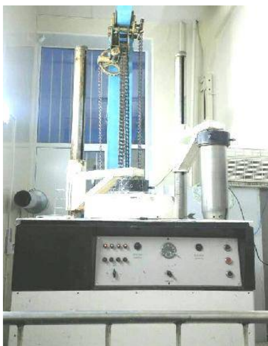
Рис. 1. Гамма-установка «Исследователь» на изотопе \text{Co}^{60}
