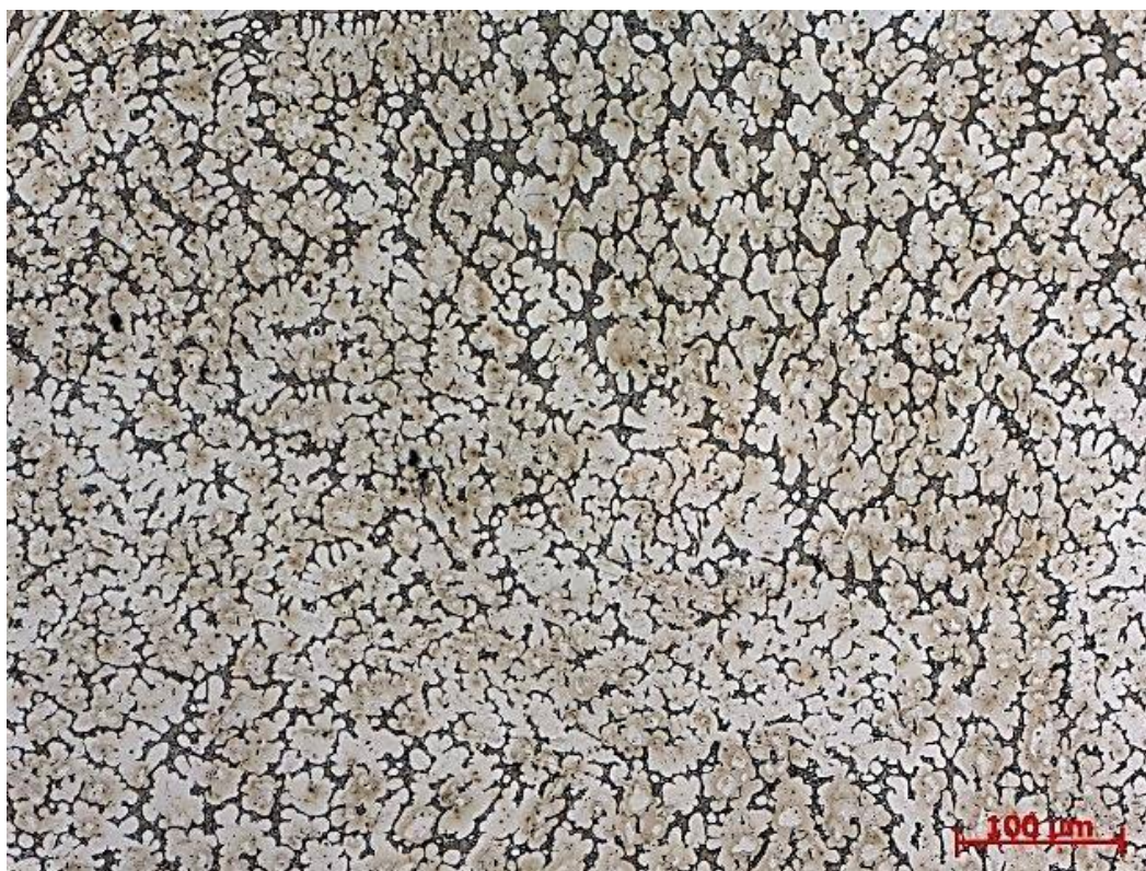
Рис. 2. Микроструктура покрытия, полученного при наплавке с током пучка 24 мА.
