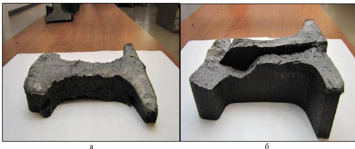
Рис. 5. Излом сварного соединения со вставкой 20 мм (а) и 5 мм (б) после испытаний по схеме трехточечного изгиба.
