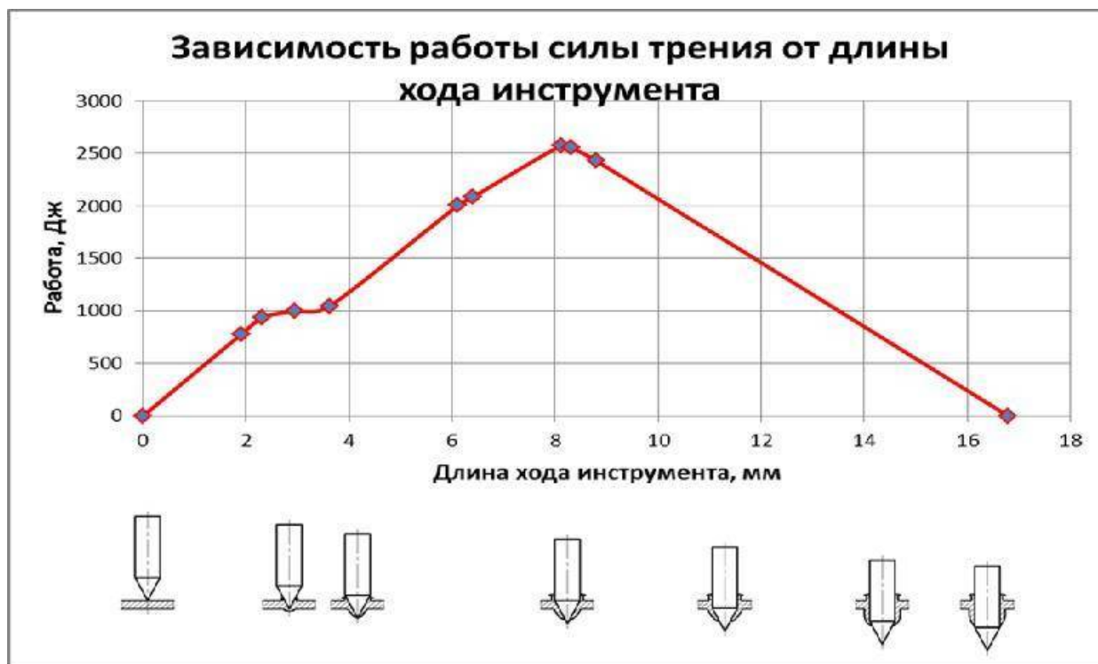
Рис. 5. Зависимость работы силы трения пуансон-сверла о металл от длины хода инструмента в процессе пластического сверления
