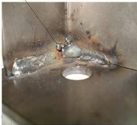
Рис. 7. Сварочный шов при значении сварочного тока 270 А, скорости сварки 16 м/ч, расход газа 9 л/мин.
