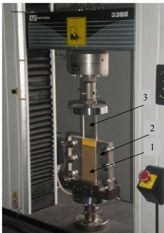
Рис.1. Стенд для проведения испытаний: 1 – образец; 2 – матрица; 3 – пуансон
