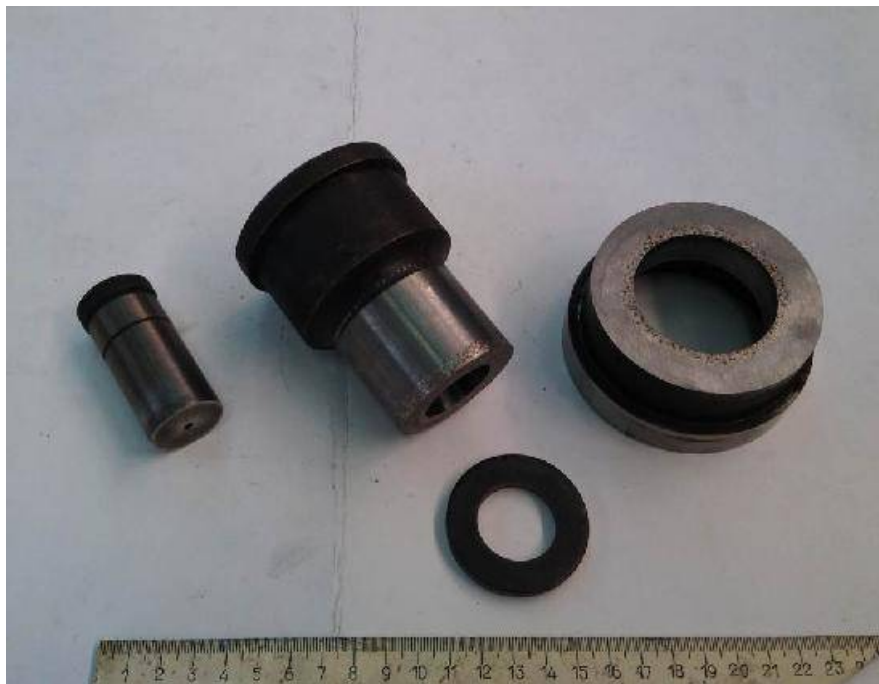
Рис. 1. Комплект штамповой оснастки (слева направо: пуансон, пуансон-матрица, матрица) и штампуемое изделие – шайба 22
