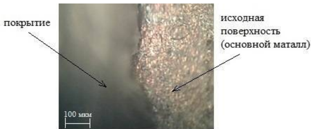
Рис.2. Увеличенное изображение исходной поверхности на границе отслоенного участка покрытия
