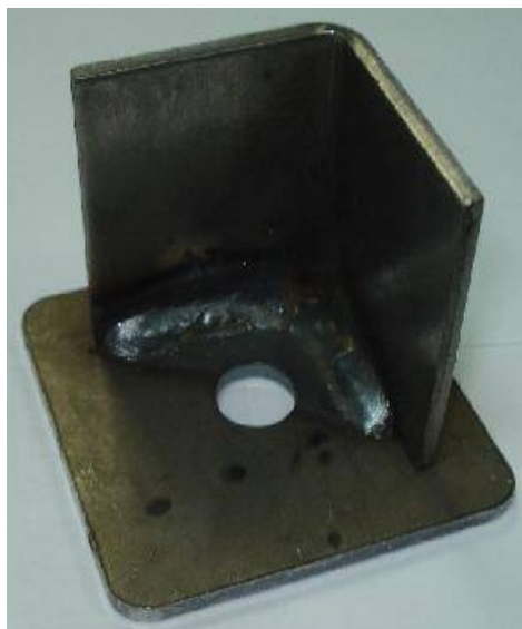
Рис. 6. Сварочный шов при значении сварочного тока 250 А, скорости сварки 15,5 м/ч, расход газа 9 л/мин
