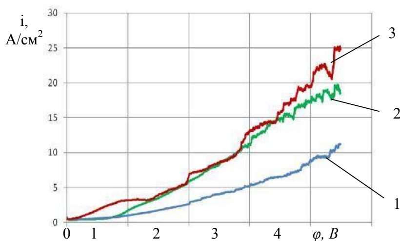
Рис. 1. Поляризационные кривые анодного растворения порошковой смеси ПС12НВК в водных растворах нейтральных солей 1 – 10% \text{Na}_2\text{SO}_4 , 2 10% \text{NaNO}_3 , 3 - 10 % \text{NaCl}
