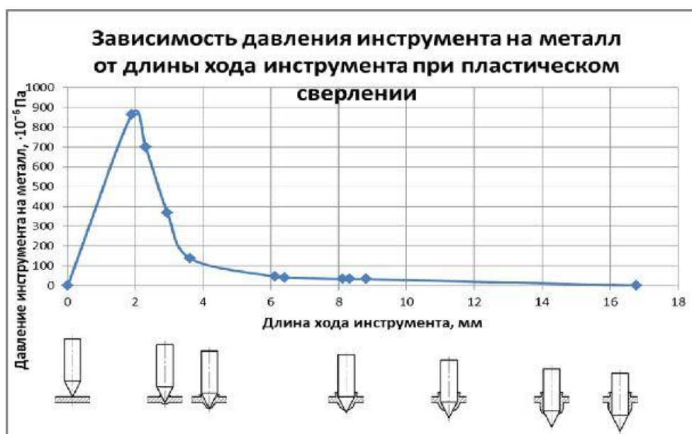
Рис. 4. Зависимость давления пуансон-сверла на металл от длины хода инструмента в процессе пластического сверления
