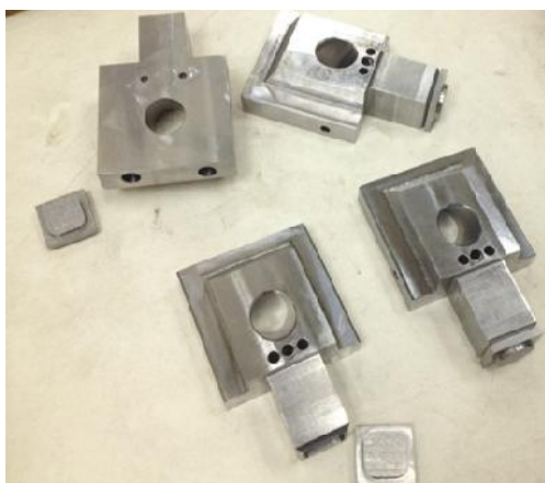
Рис. 5. Разъёмная конструкция БЗ. Подвижные элементы конструкции перед сваркой
