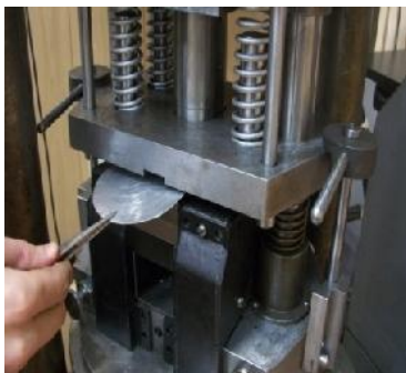
Рис. 4. Внешний вид штампа для реализации комбинированной технологии «вытяжка – обрезка припуска»
