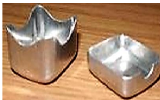
Рис. 5. Внешний вид детали: после операции вытяжки, без обрезки припуска – слева, и с магнитно-импульсной обрезкой - справа
