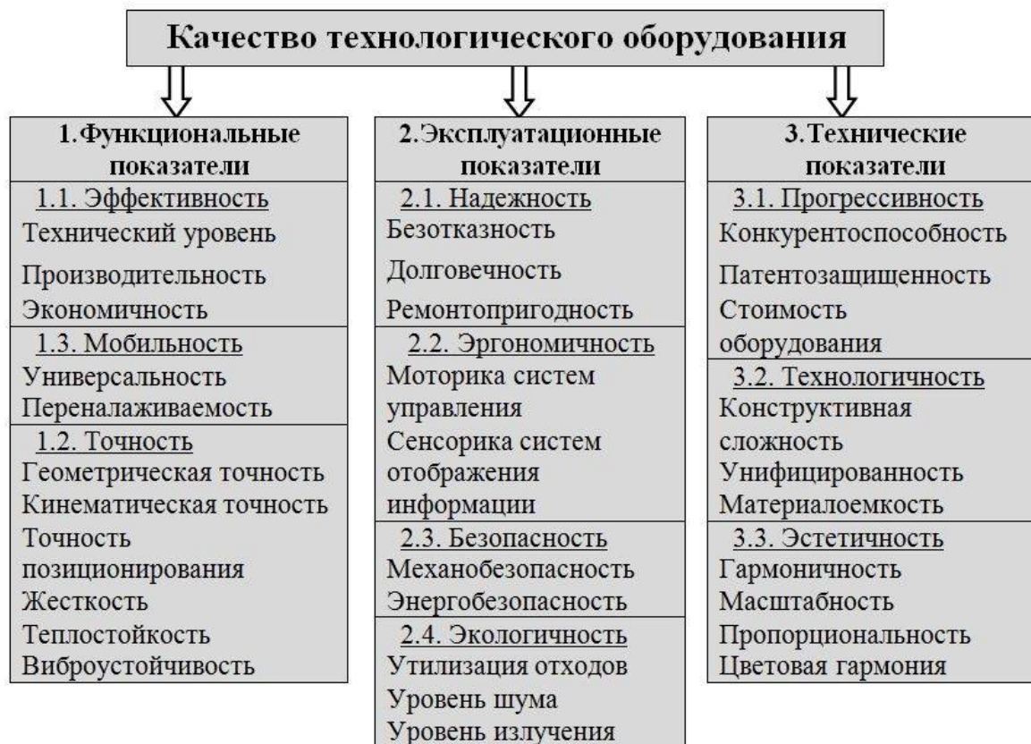
Рис. 2. Классификация показателей качества технологического оборудования
