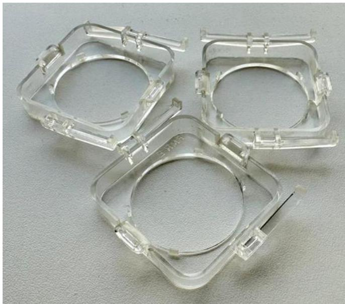
Рис. 1. Вышедшие из строя фиксаторы кнопок пассажирского лифта
