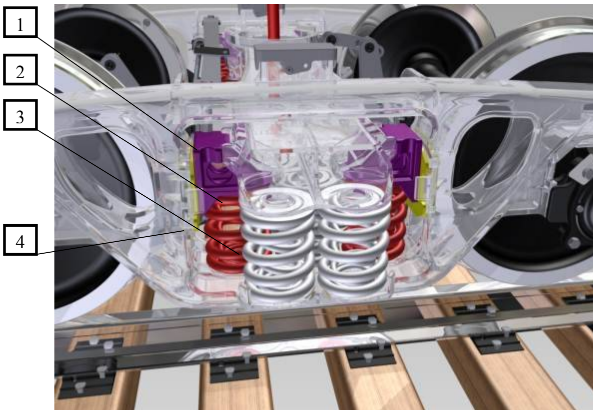
Рис. 1. Рессорное подвешивание тележки модели 18-100 (1 – Клин фрикционный, 2 - комплект двухрядных подклиновых пружин, 3- комплект двухрядных пружин, 4 – планка контактная)
