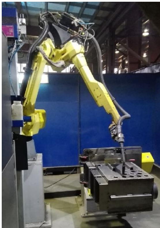
Рис. 1. Манипулятор FANUC ARC Mate 120iC/12L и двухосевой позиционер FANUC
