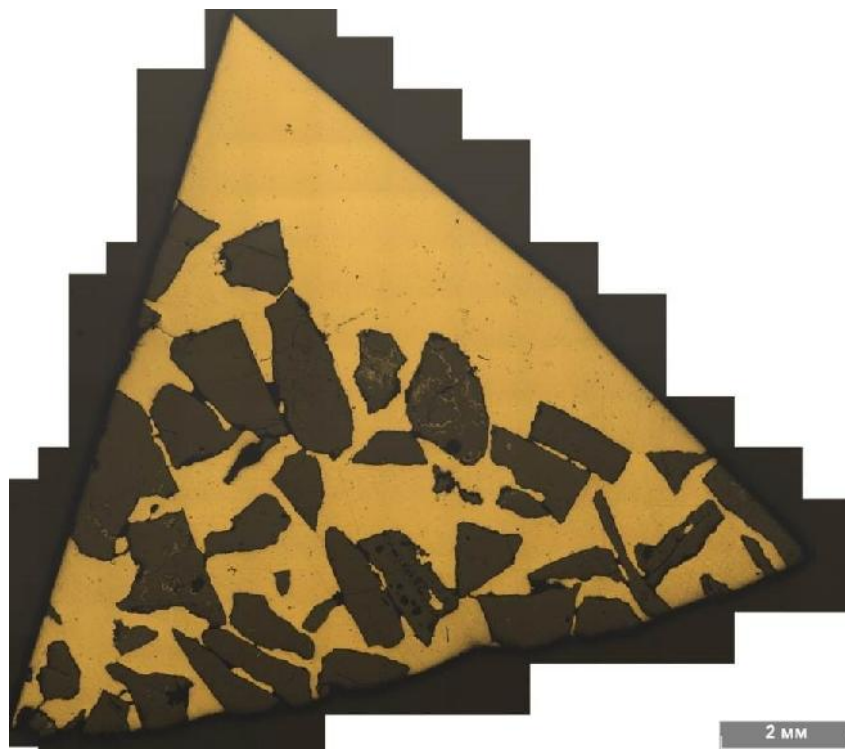
Рис. 1. Общая микроструктура износостойкого композита на основе ИЧХ28.
