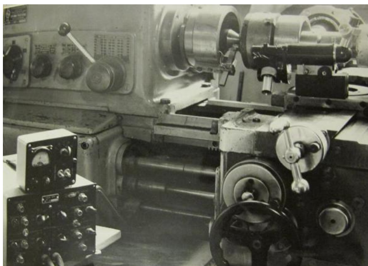
Рис. 1. Стенд для измерения силы трения при ультразвуковой упрочняюще-чистовой обработке
