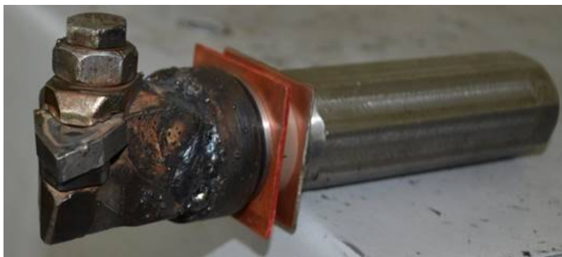
Рис. 3. Опытный образец модели инструментальной оснастки со встроенным датчиком.
