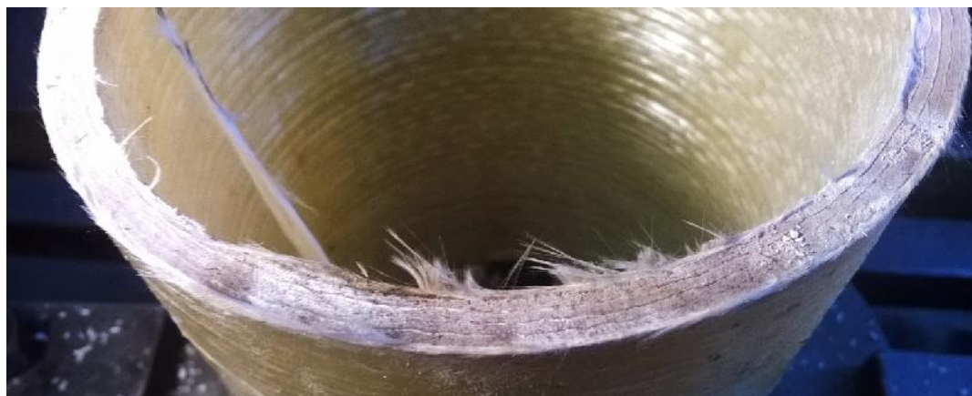
Рис. 2. Расслоение, прижоги обработанной поверхности
