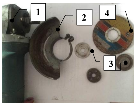
Рис. 2. Конструкция полезной модели для резки. 1-корпус, 2-защитный кожух, 3-фланцы, 4- абразивный инструмент
