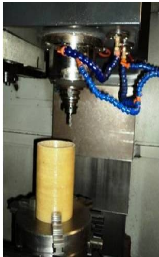
Рис. 2. Наладка станка VMC850 для проведения экспериментов
