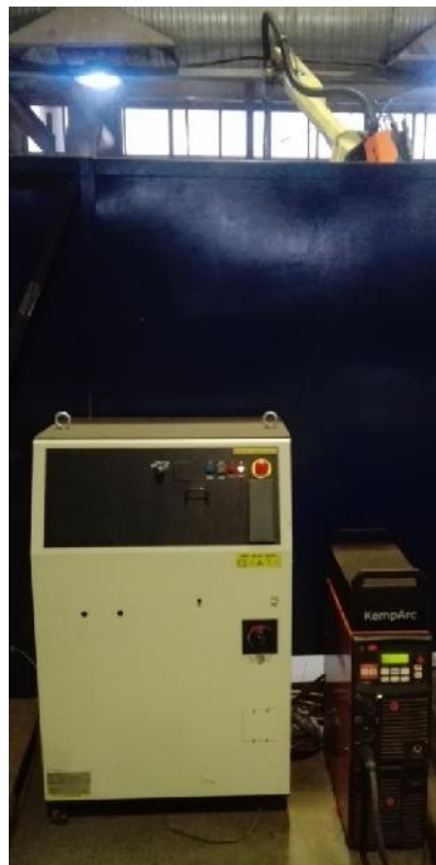
Рис. 2. Контроллер FANUC R-30iB и источник питания КЕМРПИ KemparcPulse 450
