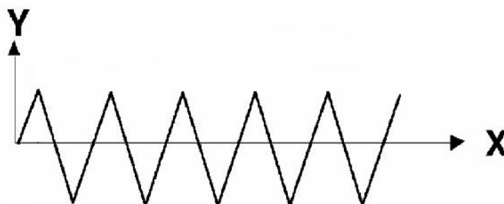
Рис. 5. Траектория линейного поперечного колебания
