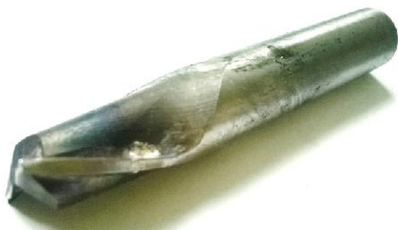
Рис. 3. Двухзубая концевая фреза (инструментальный материал Р6М5) после работы при температуре свыше 300 °С.
