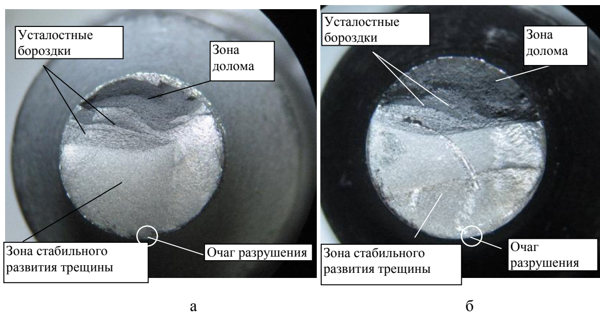
Рис. 5. Характер изломов образцов после проведения усталостных испытаний X 20 (а) – образец с цинковым диффузионным слоем (б) – образец без защитного покрытия
