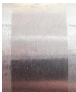
Рис. 5. Рельеф поверхности при обработке по тангенциальной схеме
