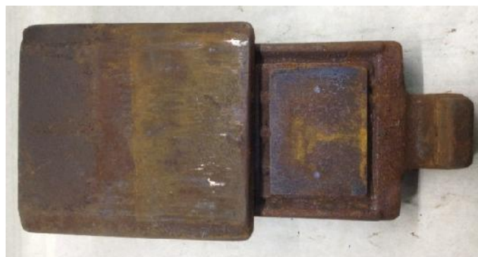
Рис. 8. Наружная часть фрикционной пластины, контактирующей с подвижной пластиной
