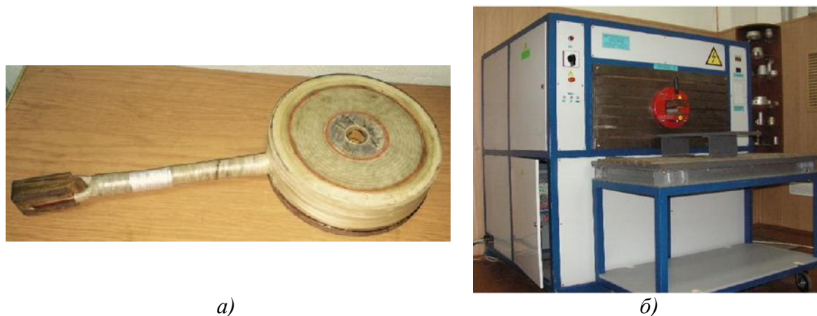
Рис. 3. Оборудование для проведения динамических испытаний а) – плоский многovitковый индуктор; б) – МИУ-50.
