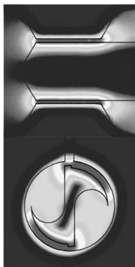
Спиральное сверло (цилиндрическая) D=18 мм; L=20 мм
