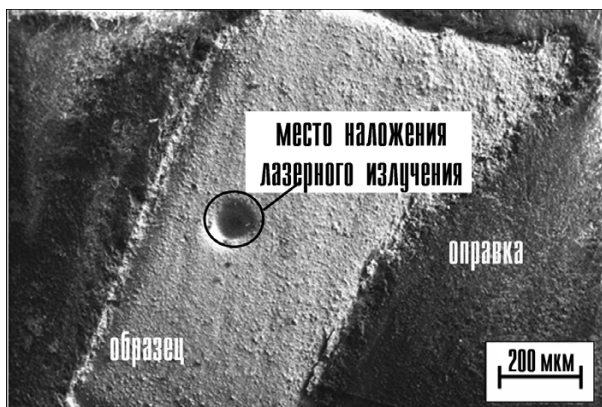
Рис. 3. Морфология поверхности твердого сплава ВК8 после ЭХРО с наложением лазерного излучения с длиной волны 0,53 мкм в 10 %-м водном растворе хлорида натрия: а – общий вид образца; б – в зоне наложения лазерного излучения
