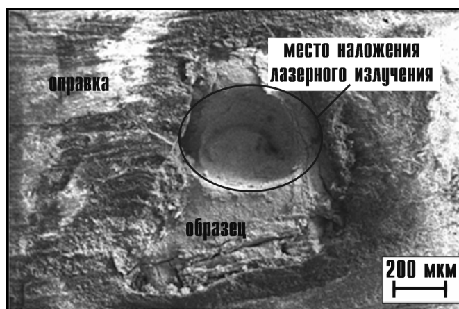
Рис. 3. Морфология поверхности твердого сплава ВК8 после ЭХРО с наложением лазерного излучения с длиной волны 0,53 мкм в 10 %-м водном растворе хлорида натрия: а – общий вид образца; б – в зоне наложения лазерного излучения
