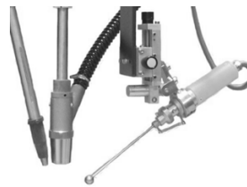
Система слежения за сварным швом с пальчиковым сенсором обеспечивает повышение уровня автоматизации процесса сварки
