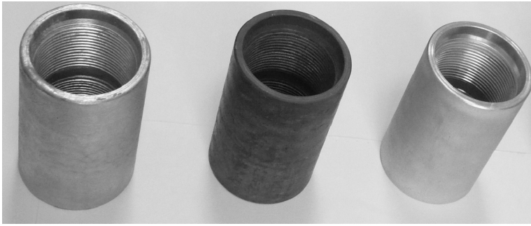
Рис. 1. Муфты НКТ с покрытиями: а – ГЦ; б – ТДЦ; в – ГВЦ
