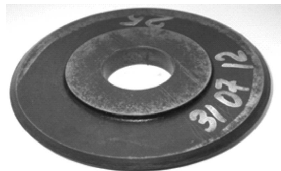
Рис. 2. Внешний вид цементованной оси из стали 18ХГТ ( a ); ножа из стали У8 с борированной поверхностью ( б )
