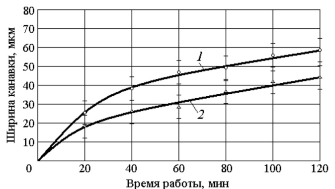
Рис. 3. Зависимость ширины канавки смятия на диске упора от времени испытаний:
