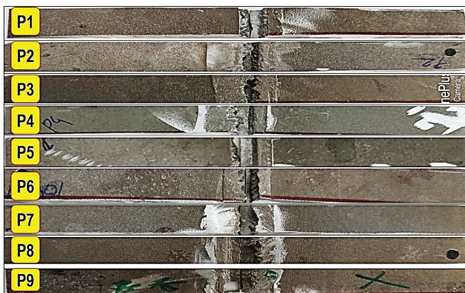
Рис. 8. Характер разрушения UVaFSW-соединений AA7075, подвергнутых дробеструйной обработке
