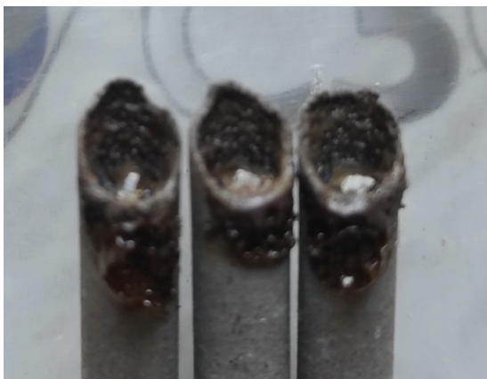
Рис. 2. Формирование «козырька» после сварки на электродах ТМУ-21У производства ООО «Судиславский завод сварочных материалов»
