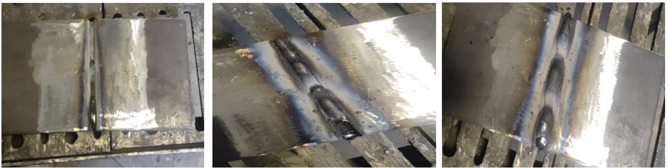
Рис. 5. Внешний вид сварного шва после заполнения электродами ТМУ-21У ЗАО «Электродный завод», г. Санкт-Петербург:
