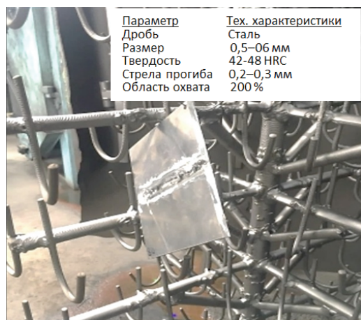
Рис. 4. Образец, установленный для дробеструйной обработки
