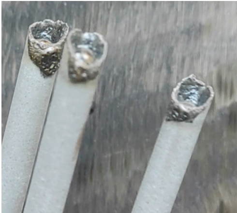
Рис. 4. Формирование «козырька» после сварки на электродах ТМУ-21У ЗАО «Электродный завод» г. Санкт-Петербург
