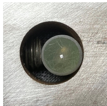
Рис. 1. Внешний вид рабочей поверхности образца для поляризационных исследований
