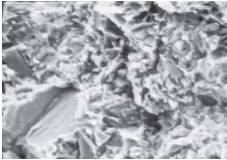
Рис. 1. Изломы слитка из опытного сплава по поперечному сечению, \times 0,8 (а) и его промежуточной части, \times 700 (б)
