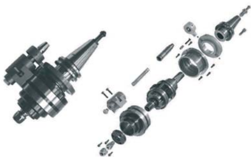
Рис. 2. Ускорительная головка и ее составные элементы
