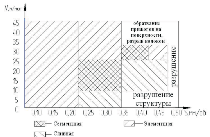
Рис. 3. Номограмма для определения вида стружки: а – для растачивания; б – для процесса сверления
