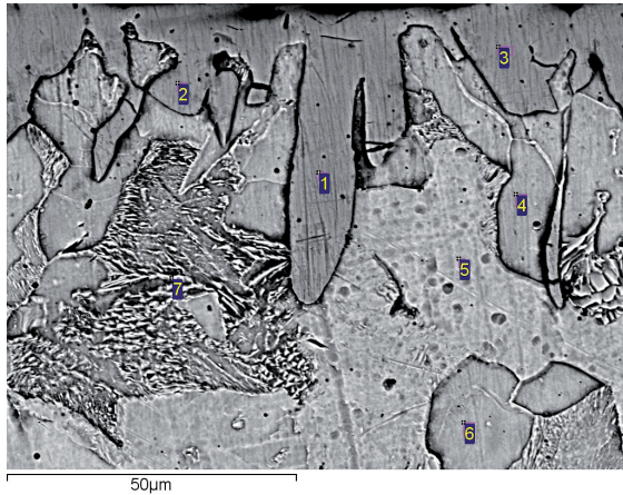
Рис. 1. Вид микроструктуры боридного слоя, полученный с помощью электронного микроскопа в отраженных электронах
