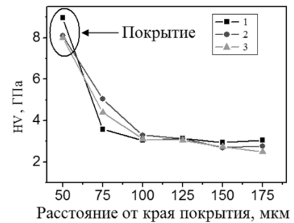
Рис. 3. Распределение микротвердости на шлифе образца (Номера линий соответствуют номерам образцов)
