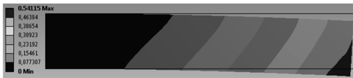
Рис. 4. Деформации закаленного стержня относительно первоначальной формы (масштаб перемещений увеличен)
