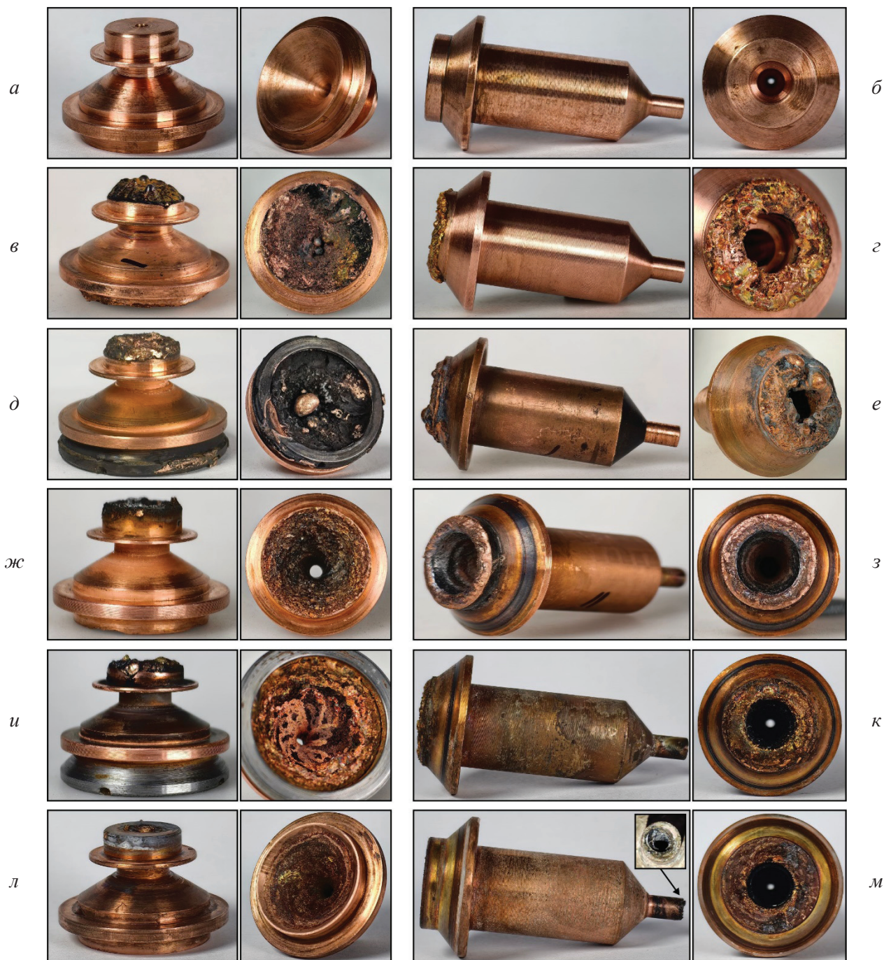
Рис. 2. Внешний вид сопел (а, в, д, ж, и, л) и электродов (б, г, е, з, к, м) до испытаний (а, б), при испытании в условии несоблюдения зазора между соплом и электродом (в, г), при испытании с оплавлением отверстий подачи газа в завихрителе (д, е), при испытании без отключения пусковой дуги (ж, з) и с недостаточно точным изготовлением сопла (и, к) в условиях низкого давления газа, при испытаниях в оптимальных режимах резки без дефектов (л, м)
