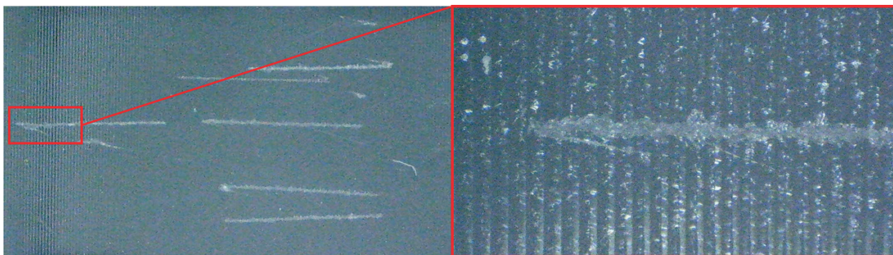
Рис. 5. Следы от прохождения иглы стилуса на эталонном образце из оргстекла с шероховатостью R_a = 1,48 мкм
