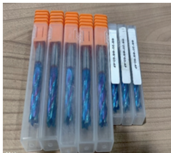
Рис. 2. Концевые фрезы из WC-Co, применявшиеся в исследовании
