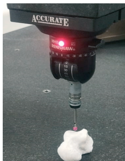
Рис. 7. Размеры таранной кости, измеренные на координатно-измерительной машине
