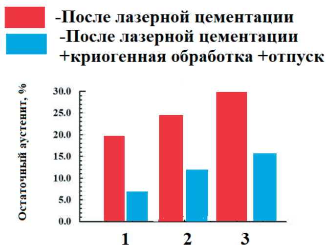
Рис. 13. Результаты снижения остаточного аустенита в науглероженном поверхностном слое стали 20 после криогенной обработки в течение 5 часов и последующем отпуске:
