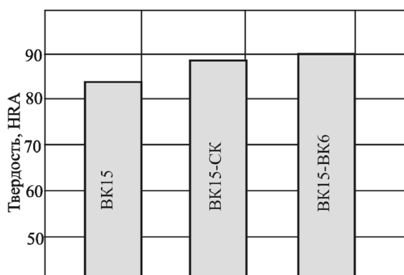
Рис. 3. Твердость поверхности вольфрамкобальтовых твердых сплавов с градиентной микроструктурой
