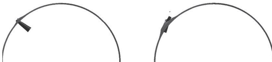
Рис. 8. Положение имитатора лопатки. Сплав – ОТ4-0. Толщина стенки корпуса 6 мм: а – удар в корпус; б – локализация имитатора после удара
