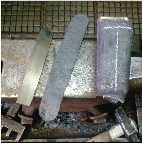
Рис. 5. Образцы белого чугуна БЧ27А послековки
