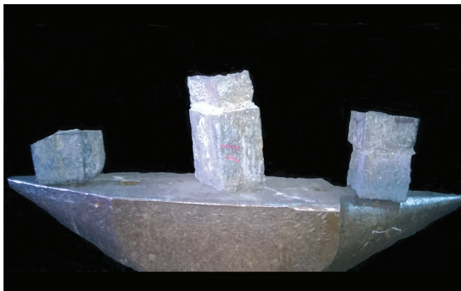
Рис. 1. Тигельные слитки ВЧ24А и ВЧ27А
