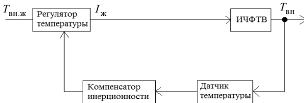
Рис. 7. Функциональная схема системы регулирования температуры с компенсатором инерционности
